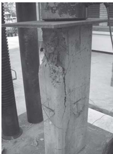
ภาพที่ 10 การทดสอบตัวอย่างเสาคอนกรีตเสริมเหล็กไม่หุ้มคาร์บอนไฟเบอร์
