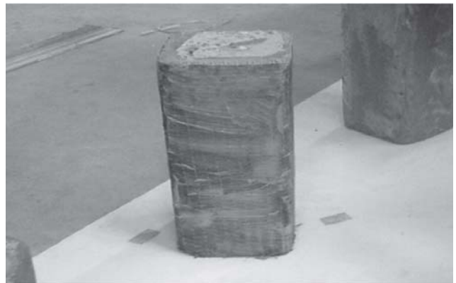
ภาพที่ 6 การหุ้มคาร์บอนไฟเบอร์แท่งคอนกรีต
