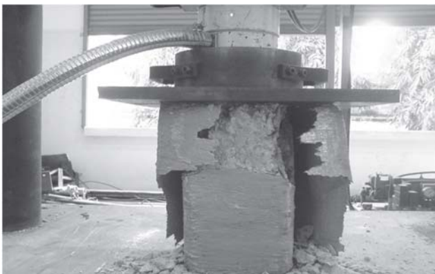
ภาพที่ 9 การทดสอบแท่งคอนกรีตหุ้มคาร์บอนไฟเบอร์
