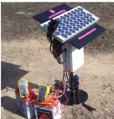
ภาพที่ 9 การทดสอบรับพลังงานแสงอาทิตย์ของเครื่องติดตามดวงอาทิตย์
