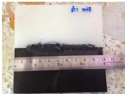
รูปที่ 10 ชิ้นงานที่เชื่อมผสมระหว่างสองสี
