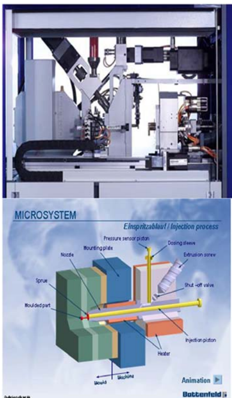
รูปที่ 7 ลักษณะโครงสร้างและหลักการทำงานของเครื่องฉีด BATTENFELD Micro50 (คุณากร เทียนแก้ว, ญัฐกรณ โปธิศรี, ไพฑูรย์ เสือคู่ย์, ศุภโชค มุกด์ทรัพย์, อานาจ ไตพิพัฒน์มงคล, 2556)
