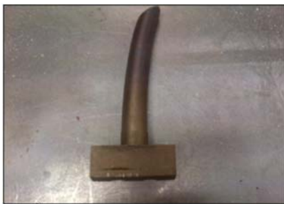
รูปที่ 18 ชิ้นงานแกนคอร์ที่ได้จากกระบวนการ DMLS
