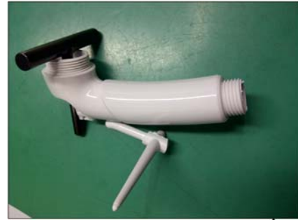
รูปที่ 7 แกนเหล็กป้องกันการเสียรูปของชิ้นงาน
