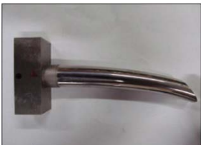
รูปที่ 19 ชิ้นงานแกนคอร์ที่ผ่านกระบวนการ EDM และขัดผิว
