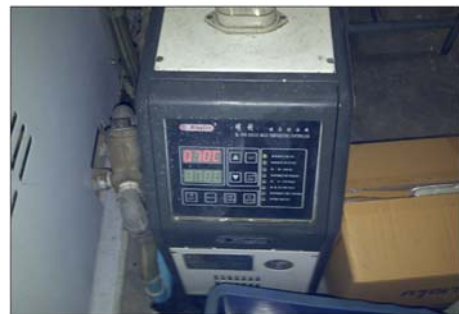
รูป 21 เครื่องควบคุมอุณหภูมิแม่พิมพ์ในการทดลองฉีดพลาสติก
