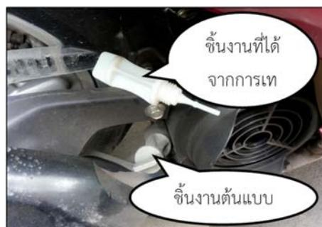
ภาพที่ 13 แสดงขึ้นงานต้นแบบกับขึ้นงานเทหล่อ
