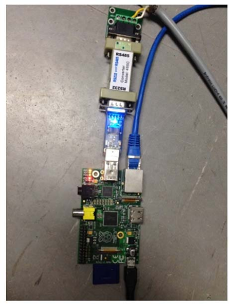
ภาพที่ 1 ส่วนประกอบของระบบผลิตไฟฟ้าแบบผสมผสาน และการเชื่อมต่อบอร์ดรึาสเบอร์รี่พาย
